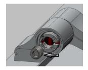
Полностью открутить прижимной винт М12.
