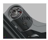
При открытой двери ослабить прижимной винт М6х5 (10).
