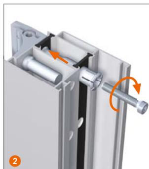
**Вставить распорную втулку. Вкрутить крепежный винт.**
