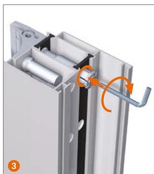
**Прижать винтом распорную втулку до прилегания буртика к профилю.**
