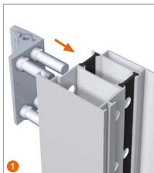
**Вставить створочную часть петли в створочный профиль согласно рисунку.**
