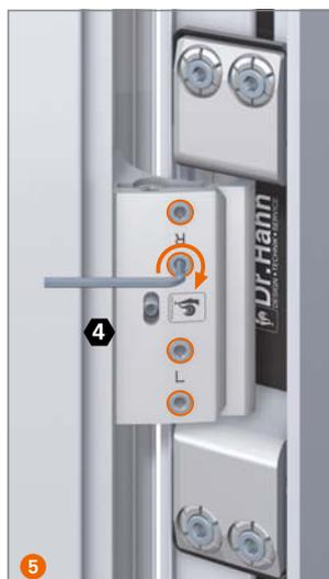
Зафиксировать прижимные винты (момент затяжки: 1,5 – 2 Nm).
